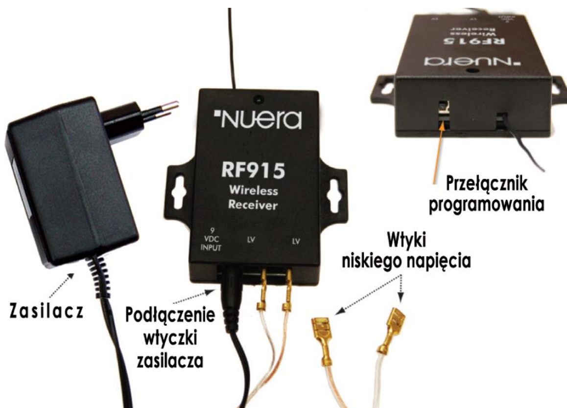
Rys. 10. Bezprzewodowy odbiornik do komunikacji odkurzacza z węzłem ssącym i automatyczną szufelką.
